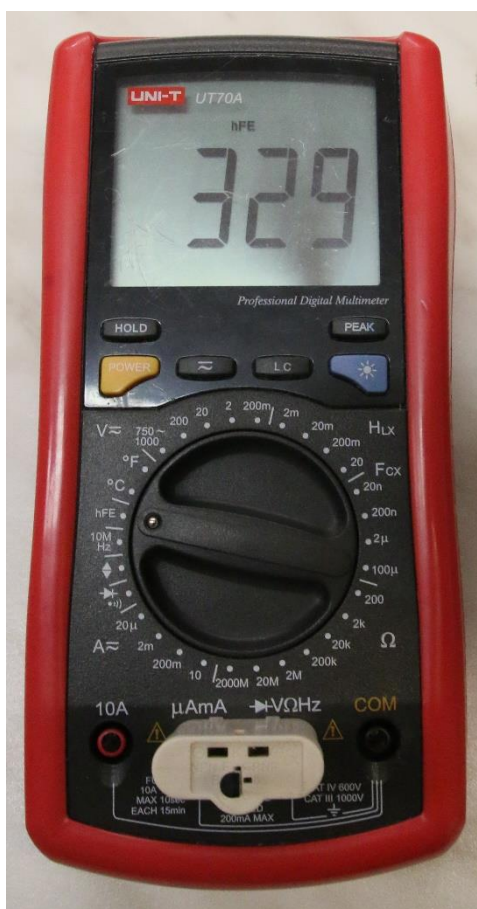
Obr. 3.1: Měření proudového zesilovacího činitele multimetrem
