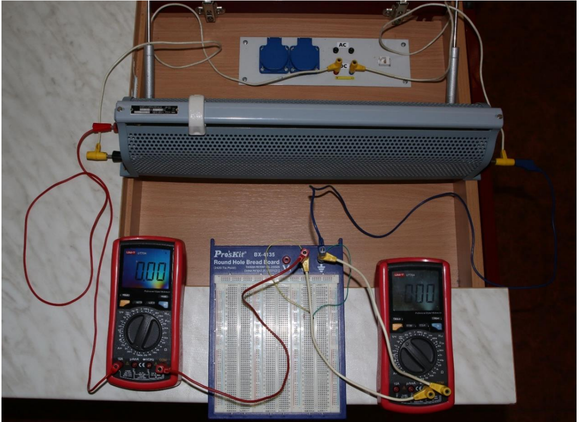
Obr. P. 4: Zapojení pro měření voltampérové charakteristiky rezistoru
