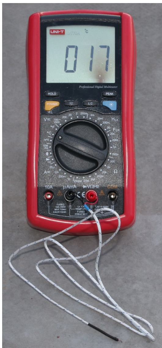
Obr. P. 1: Zapojení sondy do multimetru pro měření teploty
